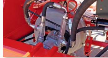
▲ -Turbine with hydraulic engine. / Turbine à moteur hydraulique.
