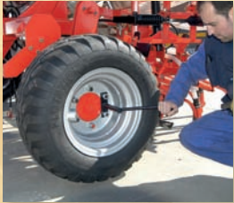
-Calibration of the dose to plant. / Calibration de la dose à semer.
