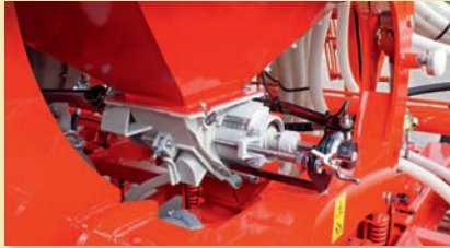
-Dispenser set with seed dose indicator. / Distributeur avec indicateur de la dose de semence.
