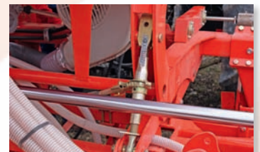
▲ -Depth regulation buzzer. / Clé à rochet pour le réglage de profondeur.
