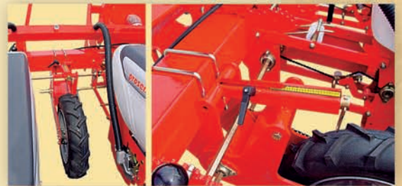
-RUEDAS TRASERAS DE DOBLE TRACCIÓN REGULABLES EN ALTURA (VERSIÓN MÉXICO).
