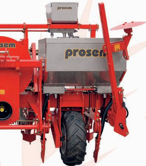
-EXCLUSIÓN AUTOMÁTICA DE FILAS CON MANDO ELÉCTRICO DESDE EL TRACTOR.
