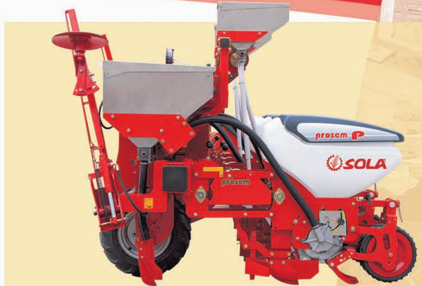
-VISTA LATERAL DE LA MÁQUINA CON TOLVA PARA SEMILLA DE 50 LITROS.
