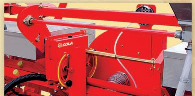
-LA REGULACIÓN DE LA DOSIS DE FERTILIZANTE EN LAS ABONADORAS, Y EN LOS MICROGRANULADORES, SE HACE A TRAVÉS DE UN VARIADOR DE VELOCIDADES DOBLE , LO QUE NOS PERMITE MODIFICAR EL CAUDAL O CERRARLO A VOLUNTAD DE FORMA INDIVIDUAL.
