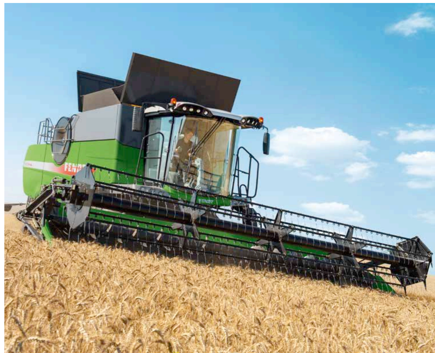
Функцията Constant Flow управлява автоматично скоростта на комбайна Fendt в зависимост от плътността на културата.
