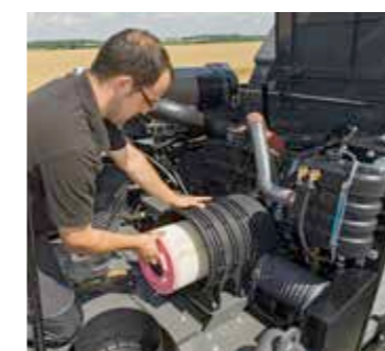
Чист въздушен филтър
