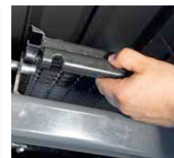
Демонтаж на ситата
