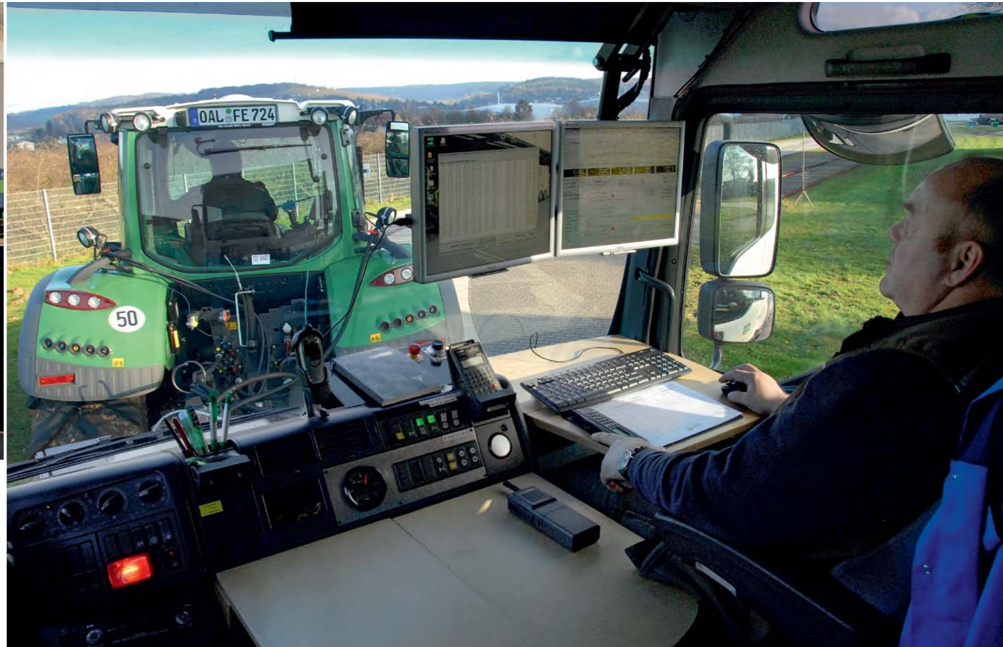
В PowerMix тестовия автомобил: протича работен цикъл с активна брана.
