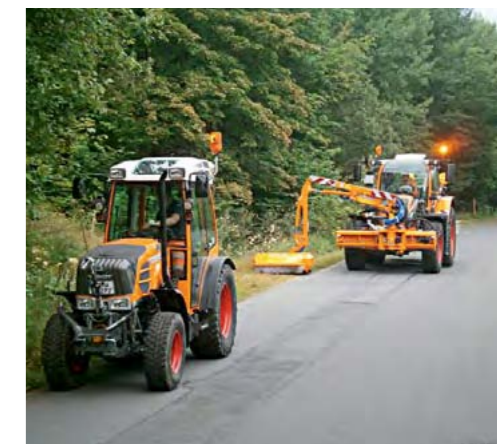
Работа с Vario x 2: Fendt 208 V Vario и Fendt 720 Vario при поддръжка на банкетите през лятото.
