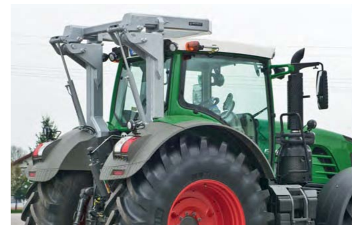
Предпазната рамка е предназначена за машини с общо тегло до 22 тона
