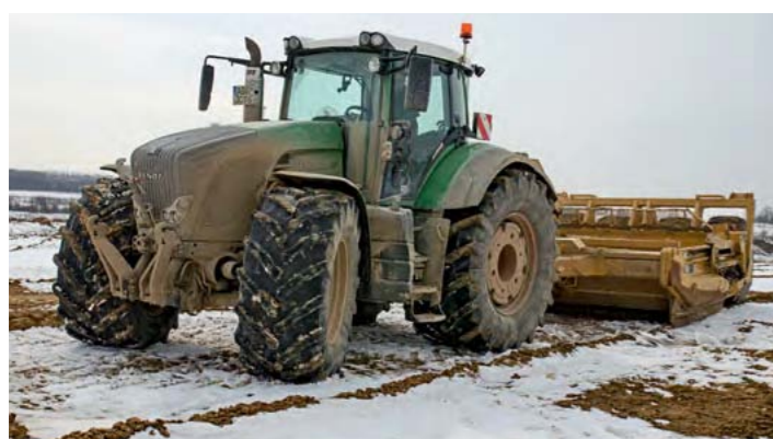
Със скрапера се премахва почвения слой, за да се достигне до пясъчните слоеве.
