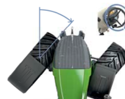
С VarioActive постигате пълно завъртане на управляемите колела само с едно завъртане на волана.
