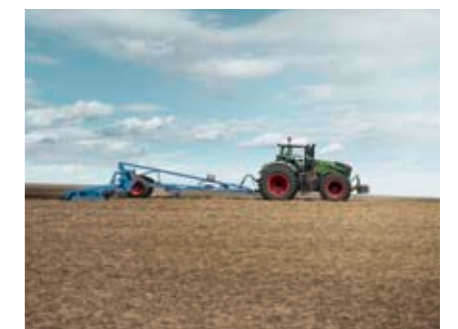
Благодарение на системата за управление на трактора TMS и автоматичното регулиране на пределното натоварване 2.0 оборотите на двигателя на трактора съответстват оптимално на скоростта на движение.
