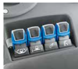
Über die Kippschalter werden bequem Funktionen wie Maisvorsatz und Pickup-Stützräder ein-/ausklappen, Neigung Vorsatz, Auswurfbogen heben/senken gesteuert.
