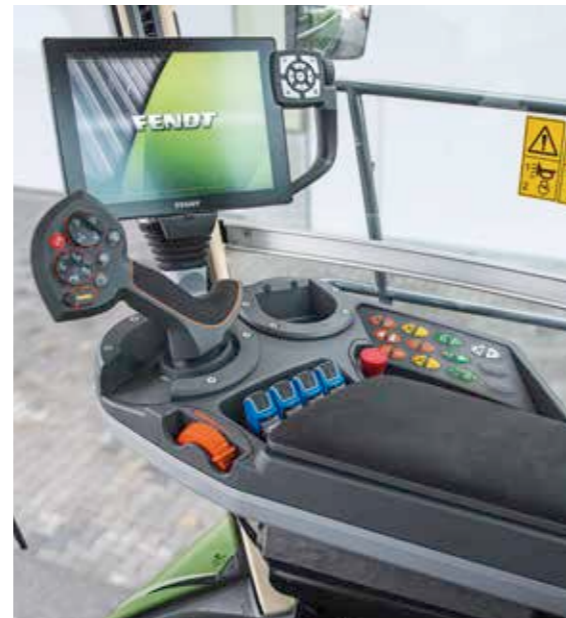
Die in den Fendt Traktoren von den Praktikern geschätzte rechte Armlehne wurde in den Feldhäcksler übernommen und angepasst.
