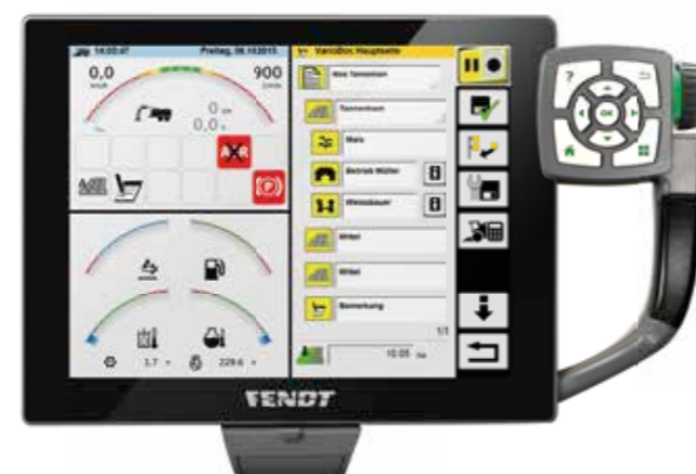
Das Fendt Dokumentationssystem VarioDoc zeichnet während des Einsatzes alle relevanten Daten zuverlässig auf.
