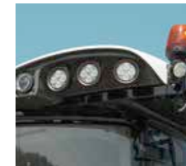
3 Paar Arbeitsscheinwerfer im Dach, Fahrlicht Dach vorne, Sidefinder und Rundumleuchte.
