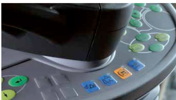
Мембранна клавиатура за блокировка на приспособлението и активиране на гасенето на вибрации.
