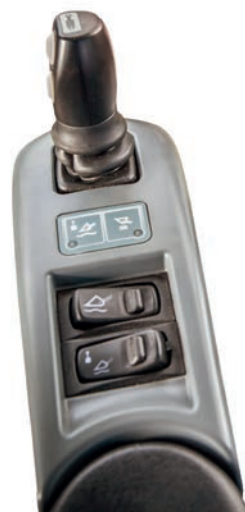
Устройството за управление на челния товарач е до седалката (опция на моделите HiTech)
