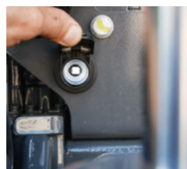
■ Отзад на машината, 12 V връзка осигурява захранване за външни потребители.
