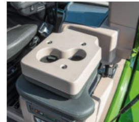
■ Допълнителната седалка, снабдена с предпазен колан, служи за стойка за бутилка, когато е сгъната.
