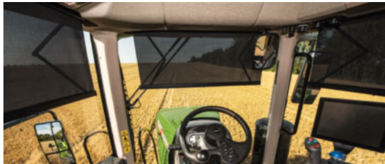
■ Ролковите сенници, разположени на всички страни, предпазват оператора от заслепяване и се скриват елегантно в облицовката на тавана.
