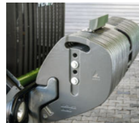
■ Крайна тежест от 990 кг може да бъде монтирана на предната рама.
