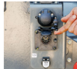
□ Отзад е предвидена 12 V връзка за външни потребители. ISOBUS извод установява връзка с инвентара.
