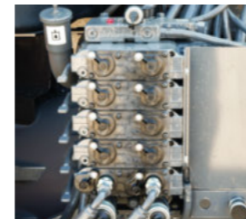
■ Отзад са разположени шест хидравлични клапана, връзка за маслен тръбопровод и Load-Sensing.
