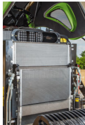
■ Големите модули за охлаждане са лесни за почистване.
