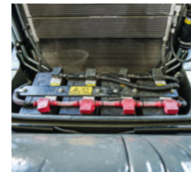
□ Четири акумулатори без поддръжка захранват Fendt 1100 MT.
