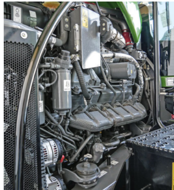
■ Дванадесет-цилиндровият двигател AGCO Power е убедителен с неговата плавна работа и лесен достъп за извършване на поддръжка.
