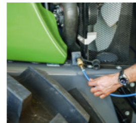
□ Една връзка за компресиран въздух е разположена отпред, за почистване на радиатора.
