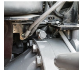
■ Двигателят е монтиран на амортизатори.
