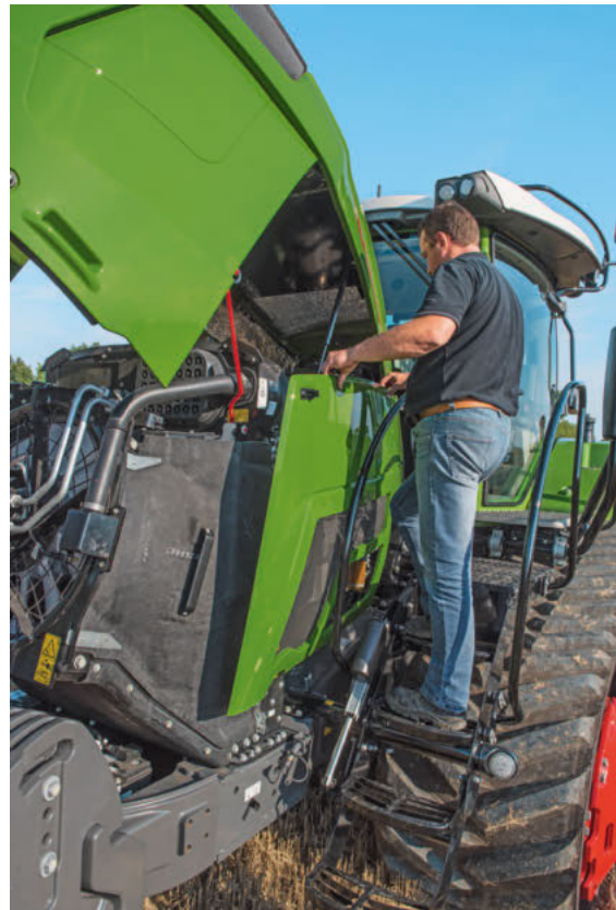
Двигателният отсек е много достъпен със свалящи се странични панели.
