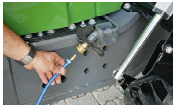
Отпред на машината има връзка за компресиран въздух, за издухване на радиатора.
