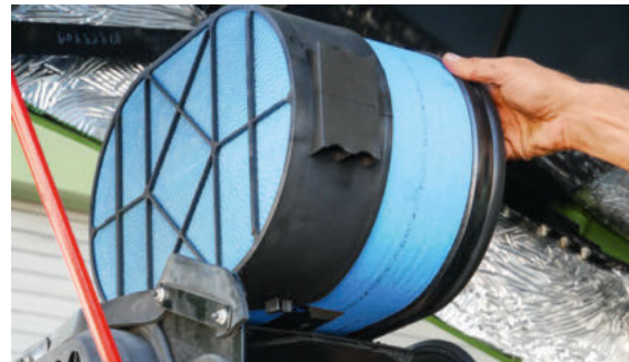
Въздушният филтър се сменя лесно и е снабден със сензор за прах, който предоставя информация за работата на филтъра.
