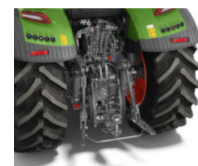
Задна навесна система със сферични краища и гумен блок
