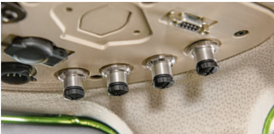
Връзки за камери 4-те връзки за камери (2x цифрови, 2x аналогови) в облицовката на покрива показват изпратеното изображение с изключително висока резолюция на терминала.
