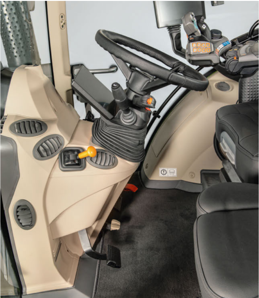
Завъртете кормилната колона с цифровото арматурно табло Цифровото арматурно табло се движи с волана. Това означава, че всеки водач може да регулира височината и наклона така, че да им пасва, осигурявайки идеалната ергономика всеки път.
