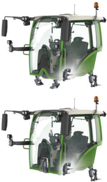
Окачване на кабината – избор от 2 версии: Пневматично: конусовидно лагеруване отпред, пневматично окачване на кабината отзад; Кабина с 4 лагера, пневматичен комфорт: 3-точково пневматично окачване на кабината (централно люлеещо рамо отпред и 2 задни опори със сгъстен въздух)
