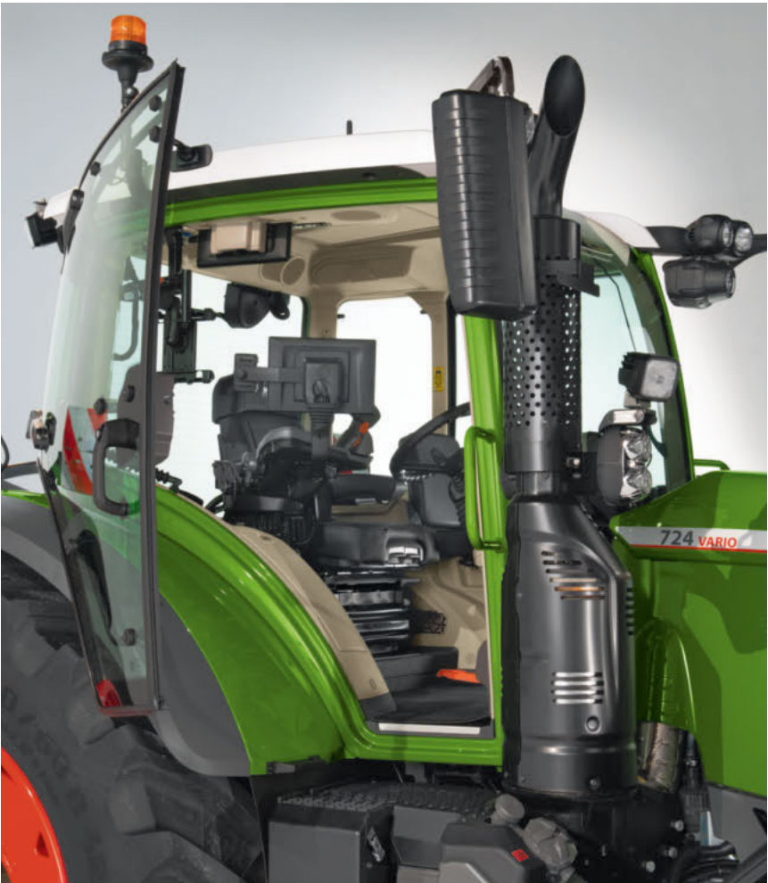
Конфигурации на кабината – избор от 3 версии: Панорамна кабина VisioPlus: Предното стъкло и дясната страна на кабината не се отварят Панорамна кабина VisioPlus + дясна врата: дясната врата се отваря, предното стъкло не се отваря Стандартна кабина VisioPlus: дясната врата и предното стъкло се отварят
