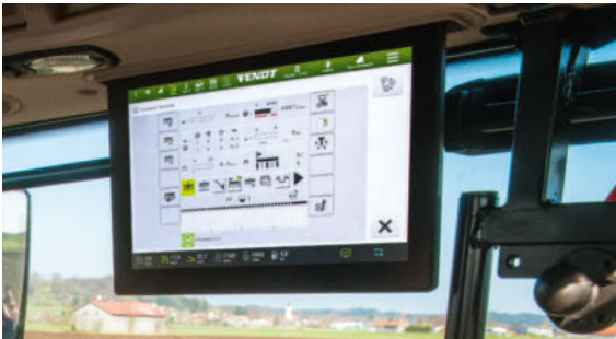
Няма нужда от външен ISOBUS терминал Допълнителният 12-инчов терминал на тавана Ви предлага дори още повече пространство на дисплея. Можете да покажете данните за своя ISOBUS прикачен инвентар на терминала на тавана, например, докато терминалът на подлакътника показва насочването по една линия. Вече няма нужда от външни терминали.
