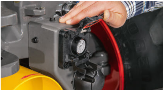
ISOBUS интерфейс Fendt 700 Vario разполага с ISOBUS гнездо отпред и отзад.
