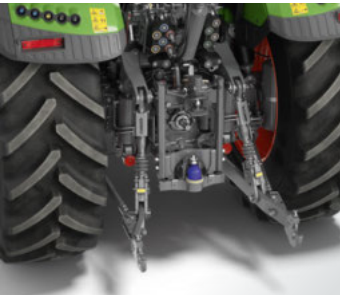
Задна навесна система с бързозахваща и странична опора (ЕС)
