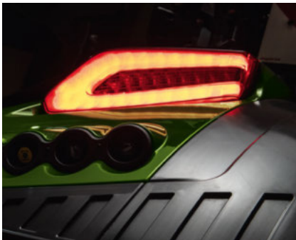
Нови LED задни светлини (с CAN способност) с динамичен мигач
