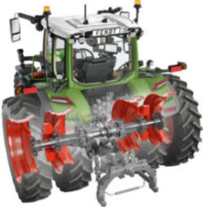
Заден мост регулируем 2 500 мм сдвоени колела с двойна главина на колелото
