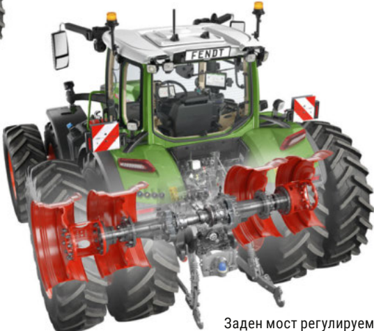
Заден мост регулируем 3 000 мм сдвоени колела с двойна главина на колелото
