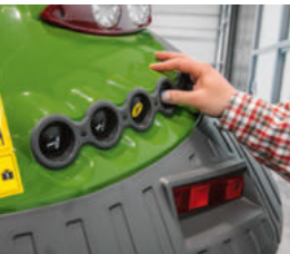
Задният подемен механизъм, VOM и един клапан могат да се управляват от заден калник.
