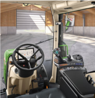
Profi Setting 1 - Кръстат лост - 1 линейен модул (кобиличен чифт) за управление на хидравличните клапани
