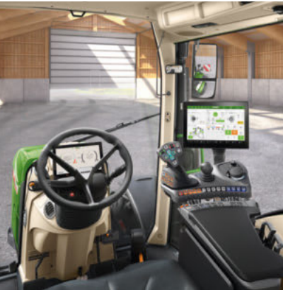
Profi+ Setting 1 - Кръстат лост - 1 линейен модул (кобиличен чифт) за управление на хидравличните клапани - 12-инчов терминал
