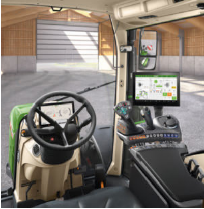
Profi Setting 2 - 3L джойстик - 1 линейен модул (кобиличен чифт) за управление на хидравличните клапани - 12-инчов терминал
