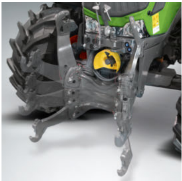
Задният подемен механизъм, VOM и един клапан могат да се управляват от заден калник.
