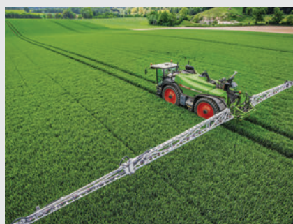
Централният шарнир на крилата осигурява дифузьорите да са позиционирани идеално и да останат стабилни в неподрязана култура
