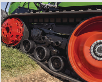
Средните ролки са активно окачени и следват контура на земята.
