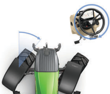
С FendtActive управление постигате пълно завиване на колелата само с едно завъртане на волана
