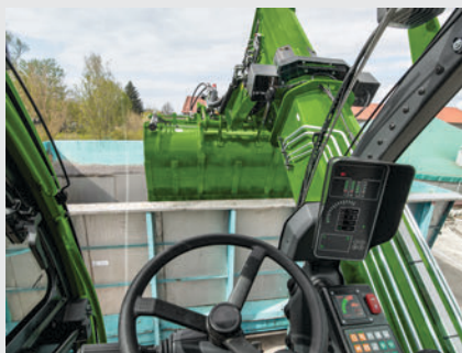
Кабината с възможност за повдигане до 4,10 м височина осигурява 360° панорамен изглед
