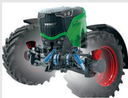
Преден мост с независимо окачване на колелата с регулируемо ниво на спирене на едно от водещите колела
