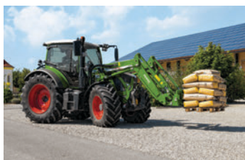
Щипка за бали с диаметър от 900 до 1900 мм
