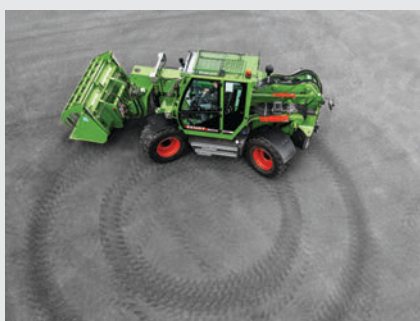
В зависимост от гумите, тясното шаси позволява радиус на завиване по-малък от 4 м.
