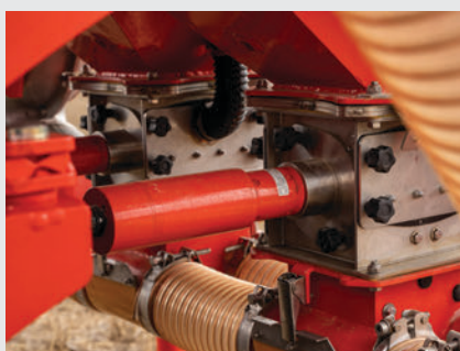
Обмен разпределител от неръждаема стомана
