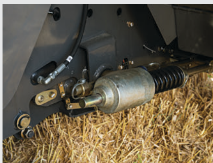
Регулиране височината на снижаване без нужда от инструменти
