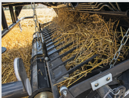
Безкамерен подбирач - безпроблемна работа без поддръжка
