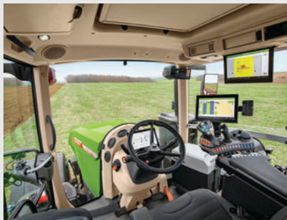
FendtONE с до три терминала за визуализация и настройки
