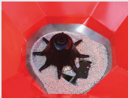
Разбърквач механизъм 17 об/мин
